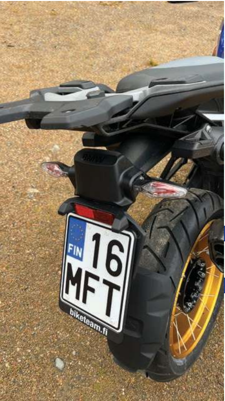
Rekisterikilven yläpuolella oleva tutka tarkkailee takana tapahtuvaa liikennettä
