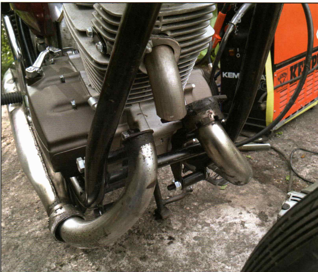
Yhdestä putkesta tulevat kiinalaiset pakokaasut piti saada menemään kahteen japanilaiseen pakoputkeen. Kemppi-liimasta oli apua tässäkin!
