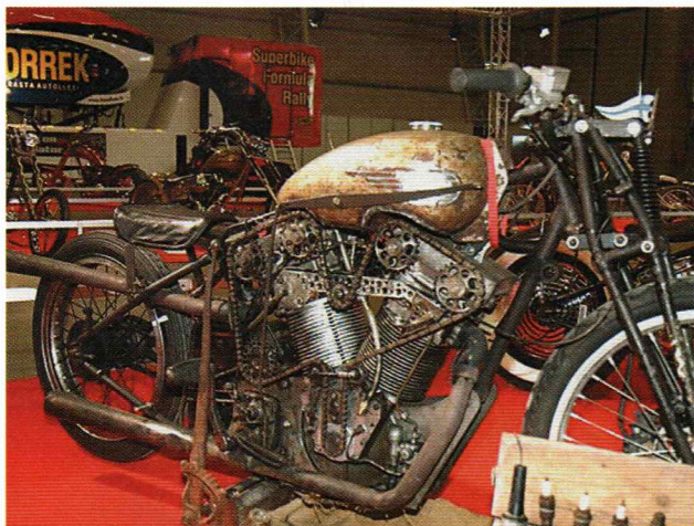
Rakennettujen pyörien huippuna voi pitää Royal Enfield 1930 mallia. 1140 cc, 210 km/h. Toimii ja pelittää. Valokuva Pekka Lankinen.
