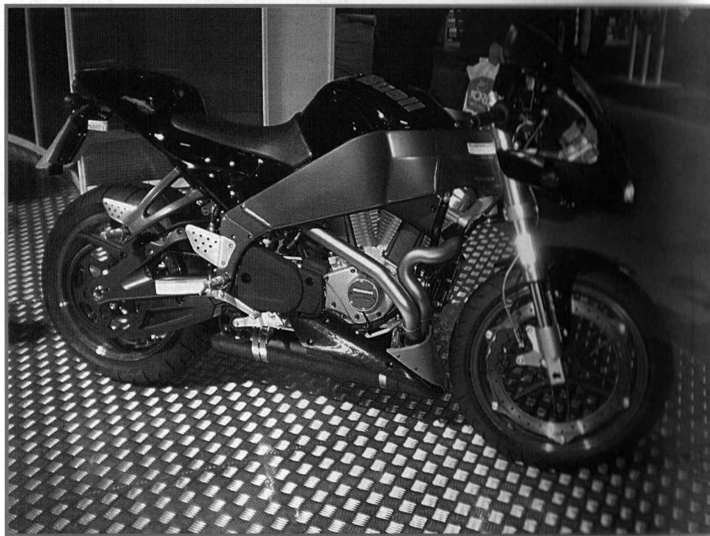
Pyörämerkkien aatelia, laadukas Buell MP-näyttelyssä. Lähes etuvanteen kokoinen jarrulevy ja hammashihnaveto. Valok. Oiva Lepola.
