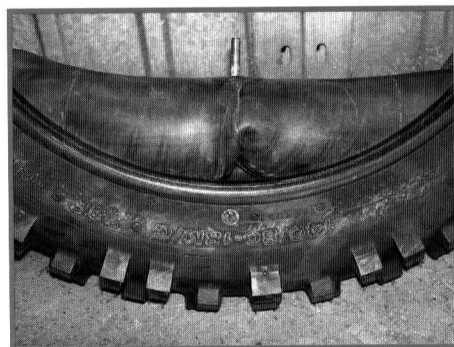
Päälirenkaan sisään pujotettu sisärenkas venttiili koholla.
