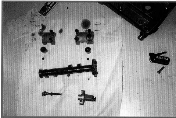
Alimpana nokkaketjun kiristin, pakonokka, säätöpalat, nostajakupit ja laakeripukit.
