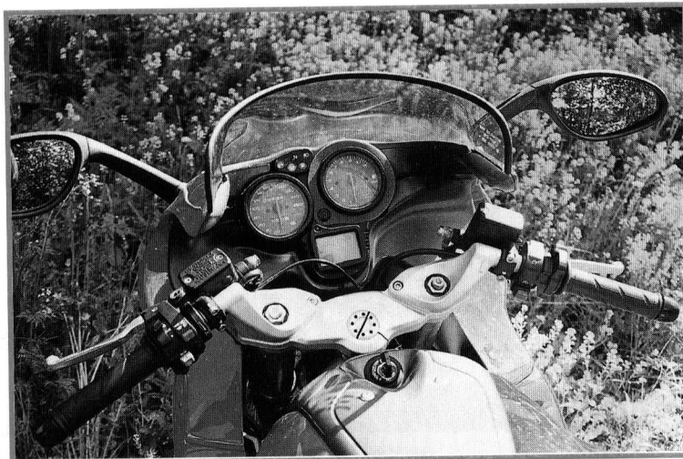
Lämpömittari, kello ja polttoainemittari LCD-näytöllä.
