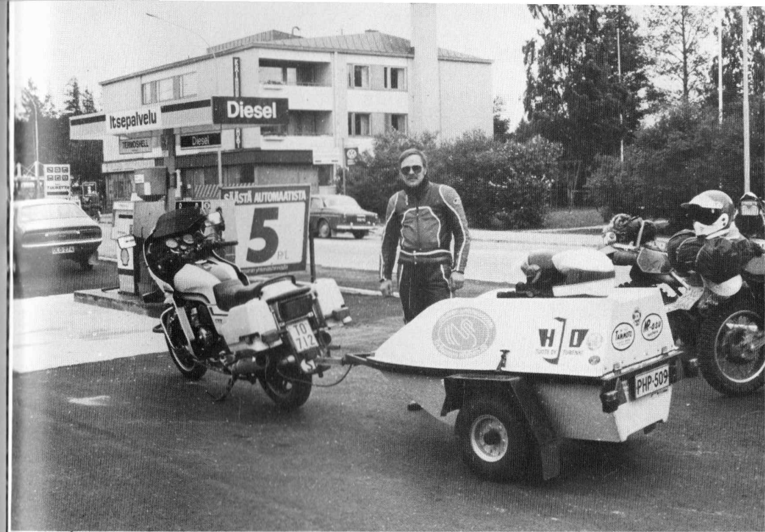
SANOISIKO TÄTÄ JO MELKEIN AMFIBIO-MOTORISMIKSI, kun Kari Syrjäsen moottoripyörän perävaununa on vene, joka toimii matkatavarasäiliönä, ja sitten muuttaman toimenpiteen jälkeen mukavana vesialuksena. Kun ollaan laiskoja soutamaan, pikku "vispilä" hoitelee riittävästi vauhtia.
