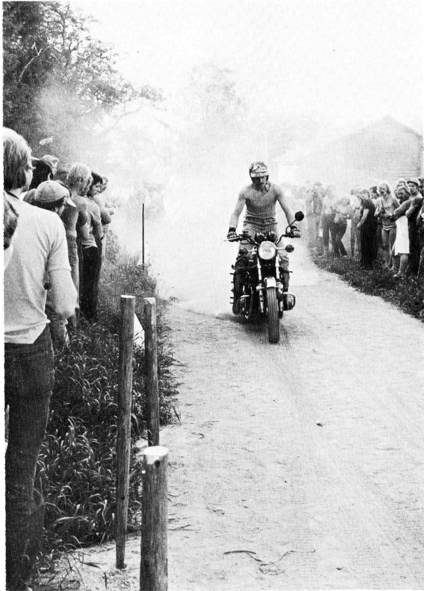
Valtaisan pölypilven ilmoille sai näytös siitä, miten pitkän jarrutusmatkan vaatii suuri moottoripyörä, kun käytetään yksinomaan vain takajarrua.
