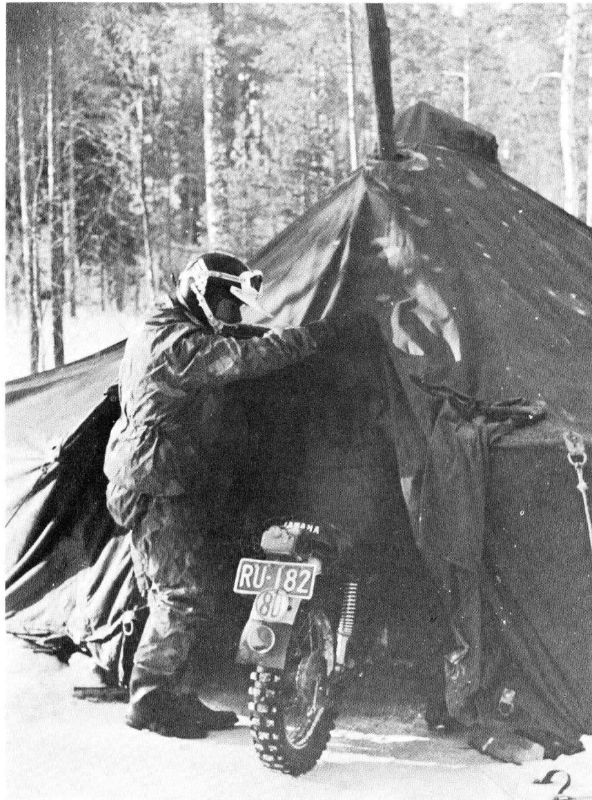
Sunnuntai-aamuinen moottoripyörien käynnistäminen kovan pakkasyön jälkeen oli- kin sitten ennennäkemätön ohjelmanumero. Suuri akku kaapeleineen kiersi pyörän luota toiselle ja useimmat pyörät oli käytettävä teltassa kaminan vieressä lämpiämäs- sä.
