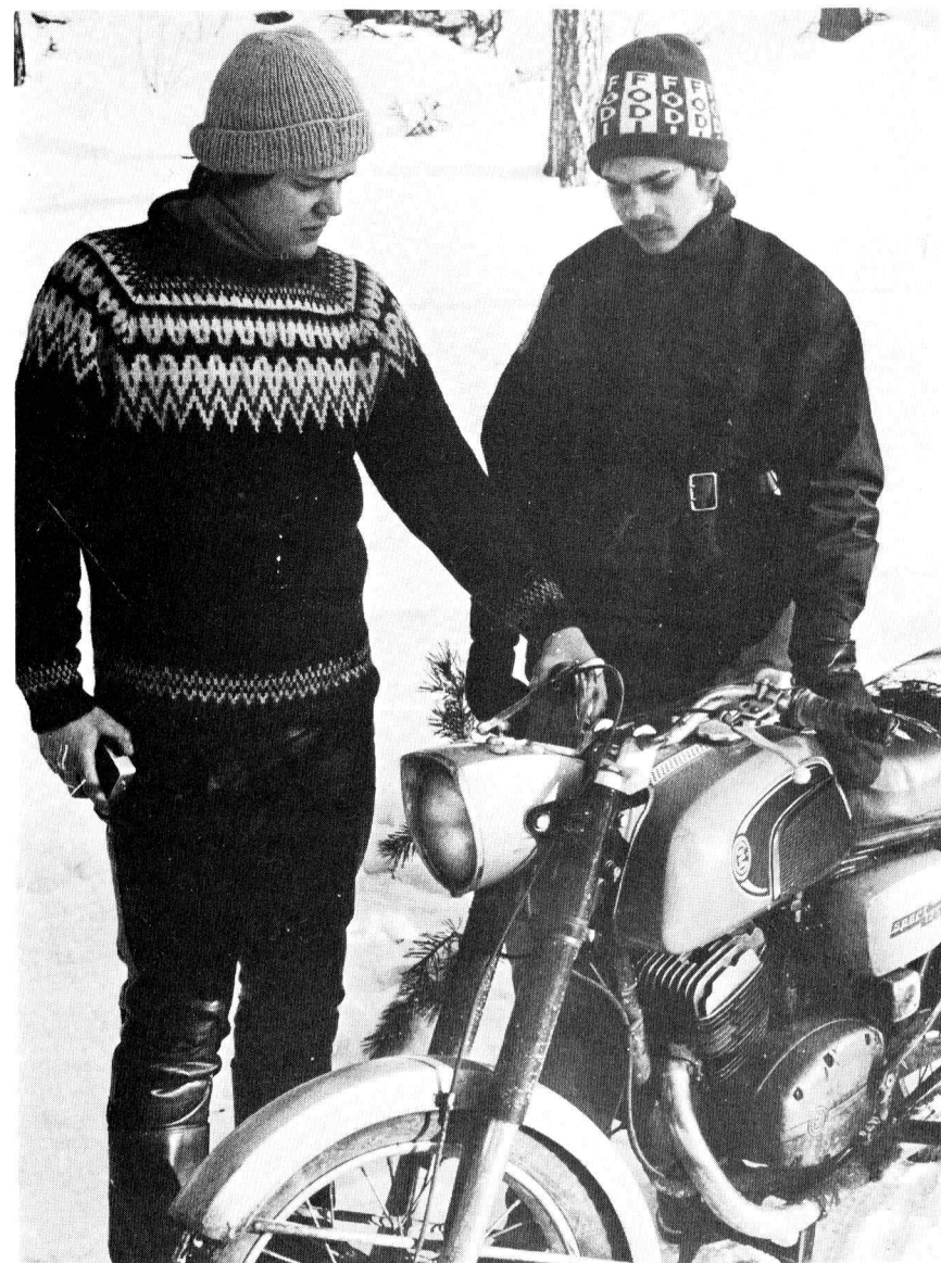
Jörgen Mandell ja Veikko Luomi olivat varustaneet ohjaustankojensa kädensijat ja saappaidensa pohjalliset sähkölämmityksellä. Idean toteuttaja Veikko (oik.) kertoi 30 watin tehon olevan riittävän ja koko rakennelman sulakkeineen, katkaisimineen ja johtoineen maksavan alta kahdenkymppin.
